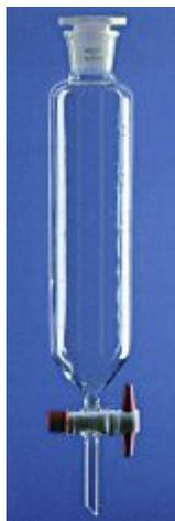
Caratteristiche: vetro borosilicato , con gambo Sono forniti di tappo in polipropilene, cono a smerigliatura normalizzata, rubinetto di scarico in PTFE e dispositivo di ritegno a vite. .
