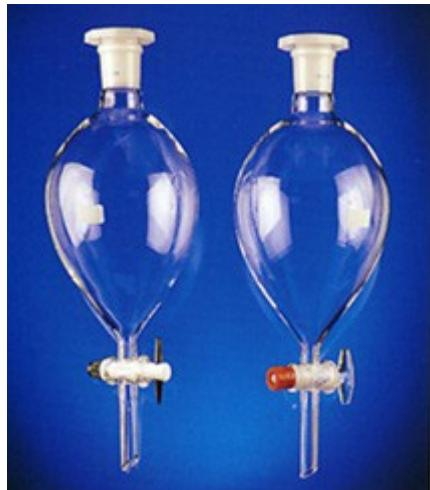
Caratteristiche: Forma unificata in vetro borosilicato Pyrex? o Duran?. Non graduati. Sono forniti di tappo in polipropilene, cono a smerigliatura normalizzata, rubinetto di scarico in PTFE e dispositivo di ritegno a vite.
