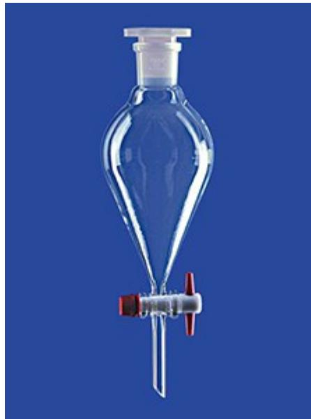
Caratteristiche: Forma unificata in vetro borosilicato Pyrex? o Duran?. Non graduati. Sono forniti di tappo in polipropilene, cono a smerigliatura normalizzata, rubinetto di scarico in PTFE e dispositivo di ritegno a vite. .
