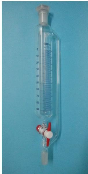
Imbuti separatori forma cilindrica con tubo compensatore di pressione a coni normalizzati.Graduati.Tappo su cono superiore.Rubinetto teflon.Vetro borosilicato. .
