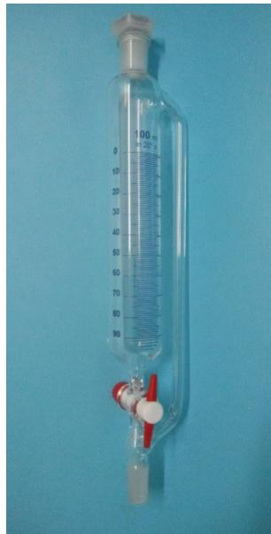
Imbuti separatori forma cilindrica con tubo compensatore di pressione a coni normalizzati.Graduati.Tappo su cono superiore.Rubinetto PTFE.Vetro borosilicato. .
