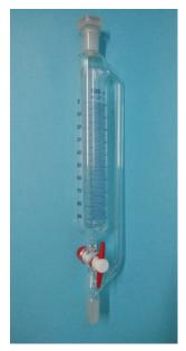
Imbuti separatori forma cilindrica con tubo compensatore di pressione a coni normalizzati.Graduati.Tappo su cono superiore.Rubinetto PTFE.Vetro borosilicato. .
