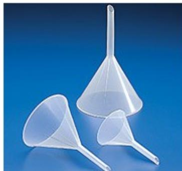
Imbuti per analisi in polipropilene, a gambo corto per tutti i normali impieghi di laboratorio. Corpo con pareti inclinate a 60° munito di scanalature, con dimensioni corrispondenti ai vari tipi di filtri sia normali che a pieghe. Sopportano temperature fino a +120° C e possono essere sterilizzati in autoclave. .
