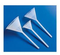
Imbuti a gambo lungoMateriale: PolipropileneCorpo angolato esattamente di 60°, munito di scanalature; Il gambo lungo si riempie di liquido filtrato creando sotto il filtro una depressione che rende più rapida la filtrazione.
