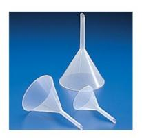
Imbuti per analisi a gambo cortoMateriale: PolipropileneStudiati per tutti i normali impieghi di laboratorio.Corpo con pareti inclinate a 60° munito di scanalature, con dimensioni corrispondenti ai vari tipi di filtri sia normali che a pieghe.Sopportano temperature fino a +120°C e possono essere sterilizzati in autoclave. .
