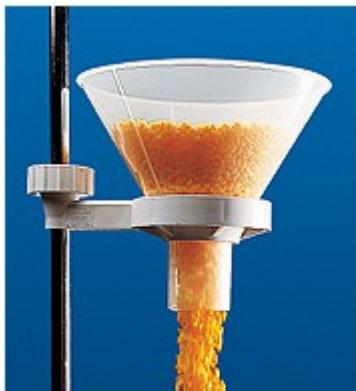
Imbuti in polipropilene, autoclavabili, realizzati per il travaso di polveri o di grandi volumi di liquido. Corpo angolato di 60° e nervature interne ed esterne. Eccelente resistenza chimica. .
