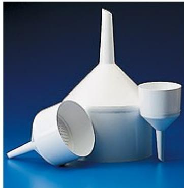
Imbuti BUCHNERMateriale: PolipropileneRobusti, leggeri, stampati in due pezzi. Possono essere facilmente separati per la pulizia.Infrangibili e resistenti alla corrosione e al calore (120°C); autoclavabili e con ottima resistenza chimica. .
