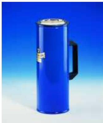
VASI CILINDRICA forma liscia rivestimento esterno in acciaio verniciato a fuoco, doppia parete argentata, sotto vuoto spinto. Particolarmente indicati per gas liquefatti.
