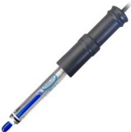
Elettrodo per pH, riempito con gel, con diaframma ad anello poroso in PTFE. Caratteristiche: Corpo in vetro. Range: 0 - 14 pH. Misurazioni a temperature elevate, fino a 100 °C. Cavo da 1 m. Per misuratori portatili. È adatto per soluzioni difficili, per esempio campioni a bassa forza ionica, creme o campioni viscosi. Fornito con un dispositivo di protezione da lavoro per evitare rotture accidentali. Ergonomico e robusto. Manutenzione ridotta.
