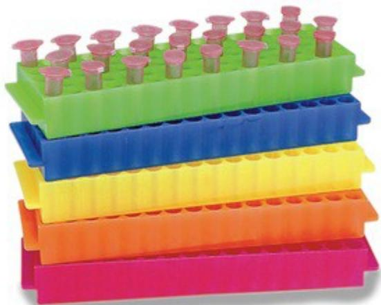
Rack di stoccaggio in polipropilene senza coperchio. Facile da riempire, organizzato in 5 file da 16 posti, per provette da 1,5/2,0 ml. La griglia impressa favorisce l'identificazione dei campioni. Autoclavabile, resiste a temperature da -90 a +121° C. Conf 5 pz.
