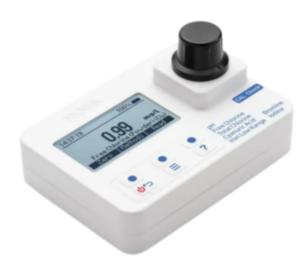
HI97722 è un fotometro portatile avanzato per la misura di acido cianurico in acqua. Questo strumento offre un sistema ottico superiore che utilizza un sensore di riferimento e filtri di interferenza a banda stretta per misure estremamente rapide e ripetibili. Fotometro portatile per Acido Cianurico (0-80 mg/l), con sistema ottico avanzato, memoria dati e protezione IP67, fornito in valigetta con standard Cal Check® e accessori, reagenti non inclusi
