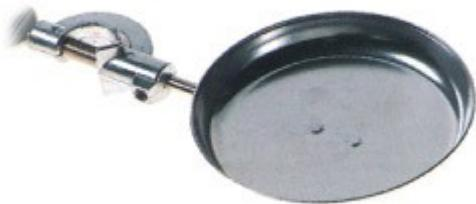
Caratteristiche: a distanza regolabile apertura del morsetto 18 mm diametro piano di appoggio del piattello 98 mm .
