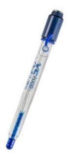
Elettrodo di pH combinato, a 3 diaframmi, per il settore caseario e alimentare. Con elettrolita Glycerin KCl ricaricabile. Testa a vite S7, senza cavo.
