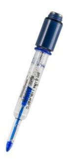
Elettrodo di pH combinato, per misure a penetrazione di campioni contenenti proteine e per il settore alimentare.con punta da 6 mm.Altezza: 25 mm. Diametro del punzone: 6 mm.Con elettrolita Glycerin KCI.Fornito con testa a vite S7, senza cavo.
