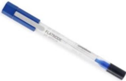
Caratteristiche principali: infrangibile. Dimensioni (LxØ) mm 120×12. Riempimento a polimero. Con membrana piatta per la misura superficiale. .
