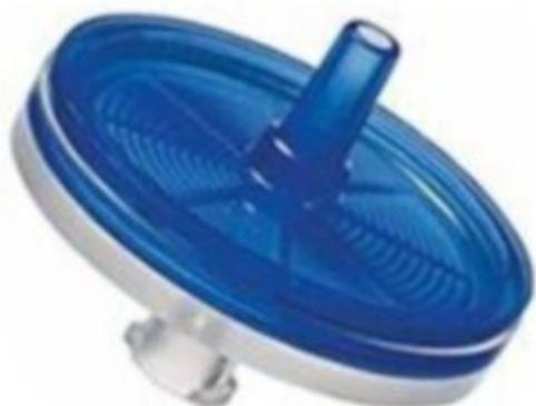
Caratteristiche principali: Molto resistenti ai solventi organici. Sono idrofobici e sono indicati per filtrare piccoli volumi di campioni e solventi per l'analisi in HPLC o GC, soprattutto quando una maggior resistenza chimica è necessaria rispetto a quella offerta dalla cellulosa rigenerata. Trovano applicazione nella filtrazione di acidi forti e soluzioni di reagenti aggressivi, nelle separazioni di fasi e nell'eliminazione dei gas dai solventi.
