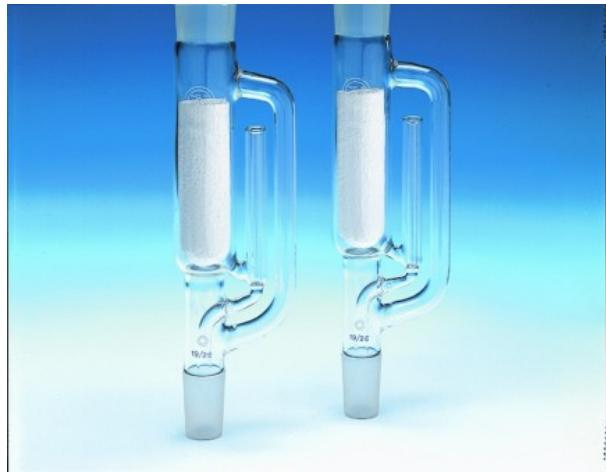
I ditali per estrazione Whatman in cellulosa e in microfibra di vetro sono caratterizzati da elevata purezza e qualità elevata e costante. Sono ampiamente utilizzati con estrattori Soxhlet e rappresentano un metodo sicuro, pratico ed efficiente per l'estrazione di solidi e semisolidi mediante solventi. L'estrazione Soxhlet è una tecnica usata di frequente per l'analisi dei grassi o dei pesticidi nei cibi e nel suolo, nonché per molte altre procedure che prevedono un'estrazione solido-liquido. .
