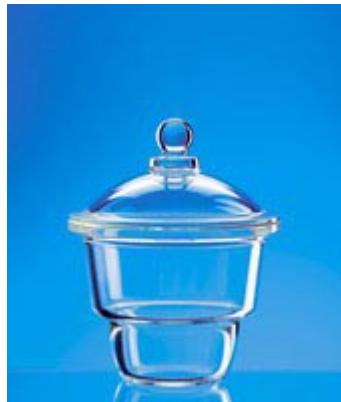
Essiccatore in vetro borosilicato con coperchio con pomolo a tenuta. Collaudati a 3 atm, assicurano una maggior sicurezza durante l'operazione di vuoto. L'altezza ridotta facilita l'inserimento in incubatore. Il fondo permette di contenere uno strato di gel di silice adsorbente di circa 2,5 cm. Forniti senza piastra di porcellana.
