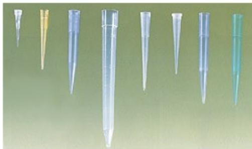
I puntali "CDL Tips" sono prodotti con polipropilene di elevata qualità, sono idrorepellenti, di grande trasparenza per vedere bene il liquido aspirato, anche se minimo, chimicamente puri, non contengono additivi, i pigmenti usati sono privi di cadmio, il cono dei puntali è rifinito con grande accuratezza e si adatta perfettamente alla micropipetta, il foro è dimensionato con precisione, con un'apertura perfettamente centrata rispetto al pistone della micropipetta. .
