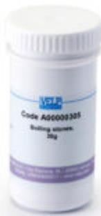
Ebollitori utilizzati per favorire un'ebollizione uniforme e prevenire il surriscaldamento durante i processi di estrazione con solvente.
