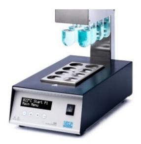
I **Digestori DK 8** sono composti da un **blocco riscaldante in alluminio** che garantisce un'elevata **omogeneità termica**, per una temperatura massima fino a 450 °C.
