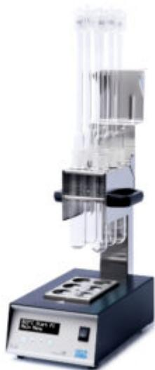
Il **DK 6** è un digestore versatile, utilizzabile sia per analisi Kjeldahl che per analisi COD per il trattamento delle acque.
