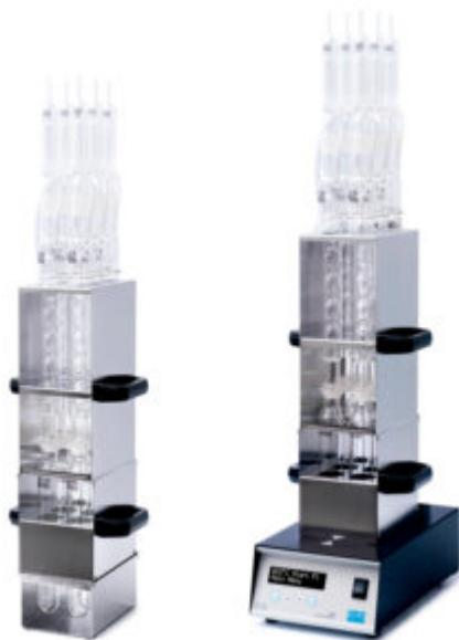
Il DK 6 e il TMD 6 sono la soluzione affidabile per la digestione con acqua regia (acido nitrocloridrico) per determinare la percentuale di metalli solubili in acidi in fanghi di depurazione, sedimenti e terreni secondo i metodi ufficiali (DIN 38414-S7).
