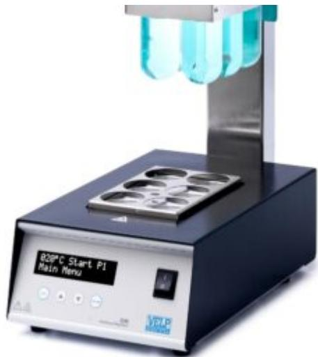
I **Digestori DK 6** sono composti da un **blocco riscaldante in alluminio** che garantisce un'elevata **omogeneità termica**, per una temperatura massima fino a 450 °C.
