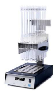
Il DK 20 è un digestore versatile che trova applicazione sia per analisi Kjeldahl che per l'analisi COD per il trattamento delle acque.
