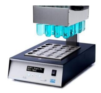
I **Digestori DK 20** sono composti da un **blocco riscaldante in alluminio** che garantisce un'elevata **omogeneità termica**, per una temperatura massima fino a 450 °C.
