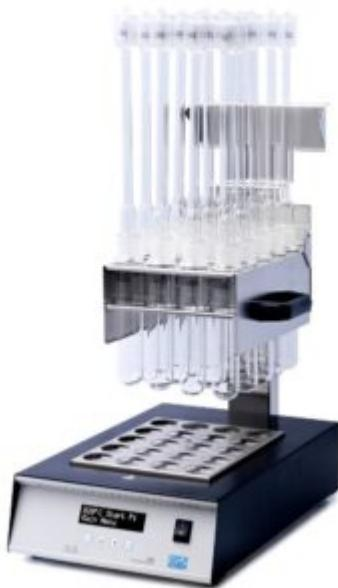
Il DK 20 è un digestore versatile che trova applicazione sia per analisi Kjeldahl che per l'analisi COD per il trattamento delle acque. Per utilizzare DK 20 per svolgere l'analisi COD (Chemical Oxygen Demand) è necessario configurare il blocco riscaldante con gli accessori specifici che permetteranno l'analisi di 20 campioni contemporaneamente.
