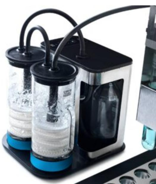
Durante la digestione Kjeldahl che prevede l'utilizzo di acido solforico, vengono prodotti fumi altamente corrosivi e pericolosi. Per garantire un completo abbattimento dei fumi prodotti durante la digestione bisogna collegare i digestori DK a:
