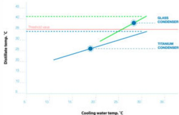
L'UDK 169 è dotato dell'esclusivo **condensatore in titanio VELP, brevettato** per garantire uno scambio termico efficiente e un basso consumo d'acqua. Mantiene la temperatura del distillato **sempre sotto 35 °C**, evitando perdite di azoto.
