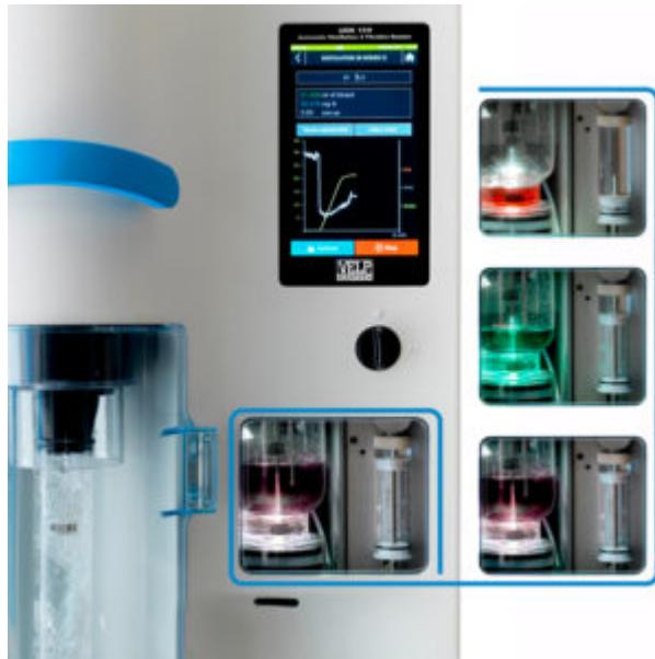
Il **titolatore colorimetrico** dell'UDK 169 garantisce **accuratezza, precisione e prestazioni elevate nel tempo**. Con un **limite di rilevazione (LOD)** di **0,015 mgN** e un **limite di quantificazione (LOQ)** di **0,04 mgN**, è ideale anche per campioni a basso contenuto di azoto.
