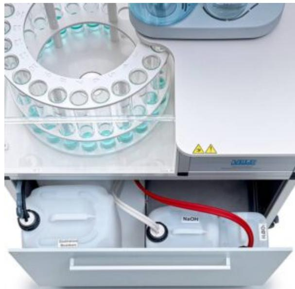
L'UDK 169 può essere utilizzato in combinazione con l'**autocampionatore AutoKjel** per processare fino a 24 campioni (provette standard da 250 ml) o 21 campioni (provette Jumbo da 400 ml) in completa autonomia. I campioni digeriti vengono trasferiti automaticamente al distillatore per risultati precisi, affidabili e sicuri, senza intervento dell'operatore. **UDK 169 & AutoKjel** sono progettati per un funzionamento continuo e automatizzato, anche nella gestione
