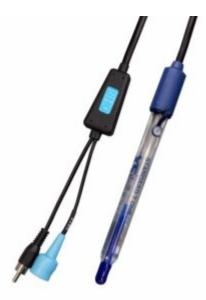
Elettrodo digitale di pH combinato, con memoria dati dell'ultima calibrazione e lotto di produzione per tutti i pHmetri con funzione DHS. Caratteristiche: Corpo in vetro e membrana cilindrica per usi generali. Dimensioni (Ø mm. 12). Cavo fisso con spina BNC +RCA Cinch. Eccellente resistenza chimica e facile da pulire.
