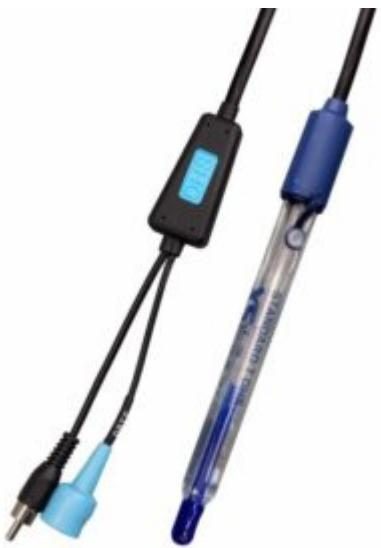
Elettrodo digitale di pH combinato, con memoria dati dell'ultima calibrazione e lotto di produzione per tutti i pHmetri con funzione DHS. Caratteristiche: Corpo in vetro e membrana cilindrica per usi generali. Dimensioni (Ø mm. 12). Cavo fisso con spina BNC +RCA Cinch. Eccellente resistenza chimica e facile da pulire.
