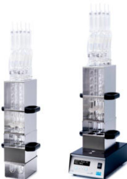
Il DK 6 e il TMD 6 sono la soluzione affidabile per la digestione con acqua regia (acido nitroidroclorico) per determinare la percentuale di metalli solubili in acidi nei fanghi di depurazione, nei sedimenti e nei terreni secondo i metodi ufficiali (DIN 38414-S7).
