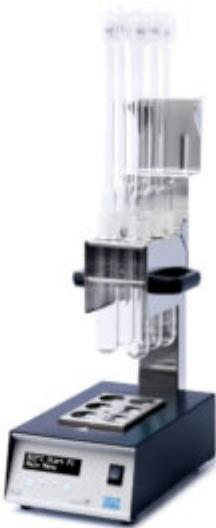
**Il DK 6 è un digestore versatile** che trova applicazione sia per analisi Kjeldahl che per l'analisi COD per il trattamento delle acque.
