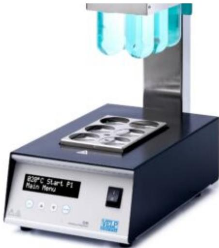
I Digestori DK 6/48 sono composti da un blocco riscaldante in alluminio che garantisce un'elevata omogeneità termica, per una temperatura massima fino a 450 °C. La temperatura del blocco è costantemente controllata da un microprocessore con una precisione di 0.5°C che lo rende particolarmente adatto alle digestioni per applicazioni Kjeldahl.
