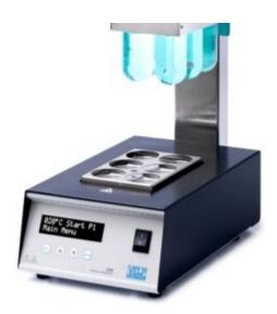
I Digestori DK 6/48 sono composti da un blocco riscaldante in alluminio che garantisce un'elevata omogeneità termica, per una temperatura massima fino a 450 °C. La temperatura del blocco è costantemente controllata da un microprocessore con una precisione di 0.5°C che lo rende particolarmente adatto alle digestioni per applicazioni Kjeldahl.
