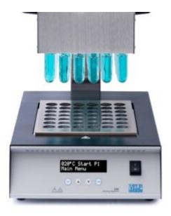
Il **display digitale** luminoso offre la massima **visibilità** e una facile lettura delle informazioni. L'inclinazione del pannello frontale lo protegge dalla fuoriuscita di sostanze chimiche ad alte temperature.
