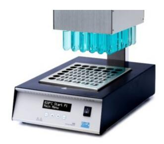
I **Digestori DK 42/26** sono composti da un **blocco riscaldante in alluminio** che garantisce un'elevata **omogeneità termica**, per una temperatura massima fino a 450 °C.
