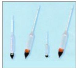
Areometro per acqua ossigenata, 10-40:0,5% precisione 1 divisione di scala lunghezza 270mm temperatura di riferimento 15°C senza termometro .
