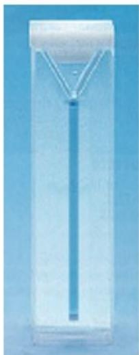
Cuvette con coperchio. Per piccolissime quantità di liquido. Due pareti smerigliate e due con fessure perfettamente trasparenti. Imboccatura interna leggermente svasata per facilitare il riempimento. Larghezza 12,5 mm Altezza 45 mm Larghezza interna 2 mm. .
