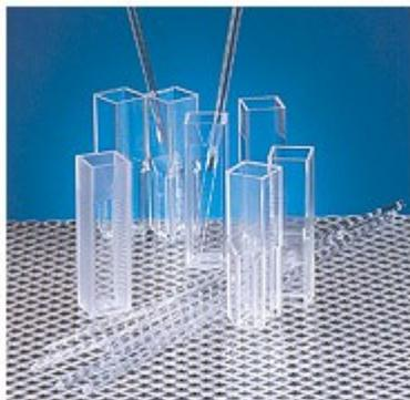
Caratteristiche principali: Cuvette monouso per spettrofotometria, modello macro e semi-micro. Con pareti lavorate otticamente per assicurare una trasparenza ottimale lungo il campo spettrale. Disponibili in polistirolo ottico con campo spettrale da 340 a 800 nm o in PMMA UV GRADE con campo spettrale da 280 a 800 nm. Dimensioni esterne (LxPxH mm): 12x12x45.
