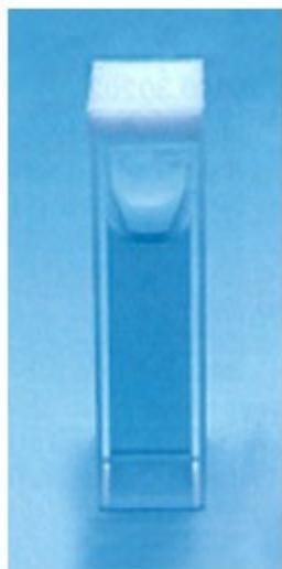
Caratteristiche: Standard con coperchio. Due pareti smerigliate e due perfettamente trasparenti. Larghezza 12,5 mm Altezza 45 mm. .
