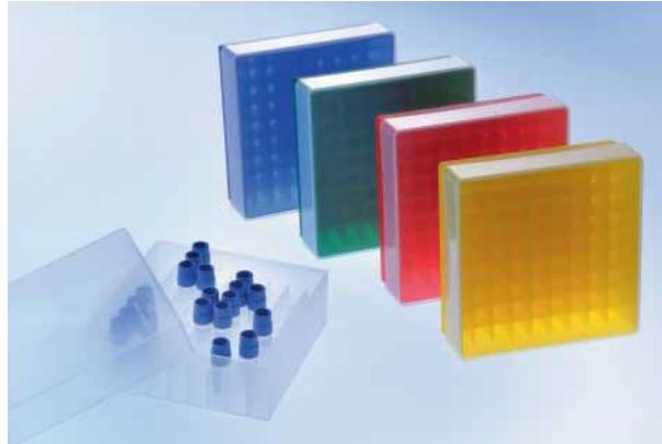
I Cryo-storage box sono degli utili accessori per lo stoccaggio di crio-tubi a basse ed ultra-basse temperature. I box sono in polipropilene molto resistente agli shock termici e sopportano temperature da -196 a +121° C. Caratteristiche: 81 posti per crio-tubi da 1/2 ml. Coperchio facilmente amovibile e trasparente per un'ottima visibilità del contenuto del box. Fori di ventilazione per facilitare lo scambio d'aria tra interno ed esterno. Disponibili in vari colori.
