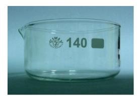
Caratteristiche: Vetro borosilicato secondo norme DIN 12 338 forma cilindrica con becco.
