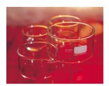
Caratteristiche: Vetro Pyrex? o Duran? a forma cilindrica vetro perfettamente trasparente e resistente agli sbalzi termici con becco per travaso
