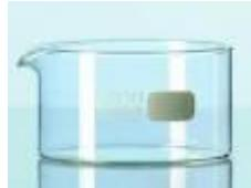
Caratteristiche: Vetro Pyrex? o Duran? a forma cilindrica vetro perfettamente trasparente e resistente agli sbalzi termici con becco per travaso
