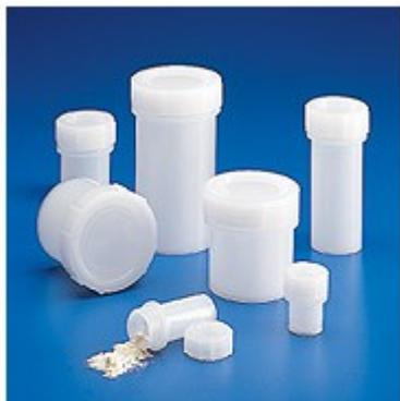
Contenitori con tappo a vite. Materiale: Polietilene. A perfetta tenuta, ideali per contenere mercurio, ecc. Piccole quantità di campione liquido o solido possono essere prelevate da questi contenitori senza problemi dovuti a ostacoli all'interno. Sono inoltre molto robusti, con pareti di elevato spessore e con eccellente resistenza chimica.
