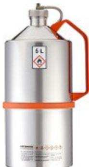
Contenitori di sicurezza in acciaio inox di alta qualità, per maneggiare liquidi infiammabili. Tutti i contenitori di questo tipo sono conformi alle richieste del TRbF60 (Technical Regulations for Flammable Liquids), sono dotati di protezione dall'esplosione e di barriera arresta-fiamme. Sono costruiti in acciaio inox tornito 1.4571/1.4301 e le guarnizioni sono in PTFE. Dotati di tappo a vite. Per applicazioni al chiuso. Spessore della parete: 0,6mm Maniglia in alluminio verniciato a polvere.
