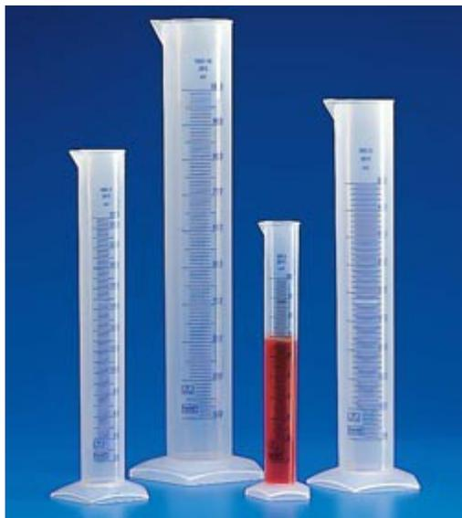
Caratteristiche: Forma alta con graduazione di colore blu in classe B Realizzati in Polipropilene speciale ad alta trasparenza. Conformi alla norma ISO 6706 - 1981 (E) Graduazioni permanenti, pareti a trascurabile bagnabilità, completa assenza di menisco. Sono dotati di base pentagonale per assicurare un'elevata stabilità. Autoclavabili a 121°C per 20 minuti e resistono a 100°C durante l'uso continuato. Idonei al contatto alimentare .
