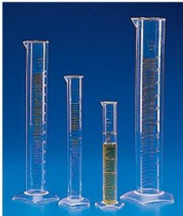
Cilindri graduati forma alta Materiale: PMP (TPX®) Realizzati secondo le Norme ISO 6706 - 1981 (E) e BS 5404 Parte 2 1977 perfettamente trasparenti, autoclavabili, possono essere usati con liquidi a temperature fino a +170°C. Trascurabile bagnabilità e assenza totale di menisco; graduazioni permanenti stampate in rilievo. Chimicamente più puliti del vetro poiché non danno luogo a cessioni o assorbimenti. Eccellente resistenza chimica; base pentagonale per assicurare un'elevata stabilità.
