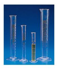
Cilindri graduati forma altaMateriale: PMP (TPX®)Realizzati secondo le Norme ISO 6706 – 1981 (E) e BS 5404 Parte 2 1977 perfettamente trasparenti, autoclavabili, possono essere usati con liquidi a temperature fino a +170°C.Trascurabile bagnabilità e assenza totale di menisco; graduazioni permanenti stampate in rilievo.Chimicamente più puliti del vetro poiché non danno luogo a cessioni o assorbimenti. Eccellente resistenza chimica; base pentagonale per assicurare un'elevata stabilità.
