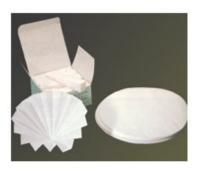
Caratteristiche principali: Per precipitati medi. Per filtrazioni veloci. Porosità fine, resistente. .
