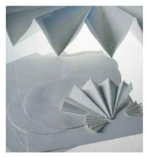
Caratteristiche principali: Velocità di filtrazione molto lenta, indicata per precipitati molto fini quali solfato di bario ed acido metastannico. Sono disponibili anche misure diverse da quelle indicate. .
