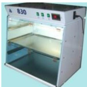
La cappa per PCR MOD. 830 grazie all'utilizzo di 2 lampade UV temporizzate, è indicata per creare un ambiente decontaminato in cui eseguire operazioni pre e post PCR, o disinfettare piccola strumentazione utilizzata per i protocolli PCR. E' di facile trasporto e può essere alloggiata su comuni banchi da lavoro.
