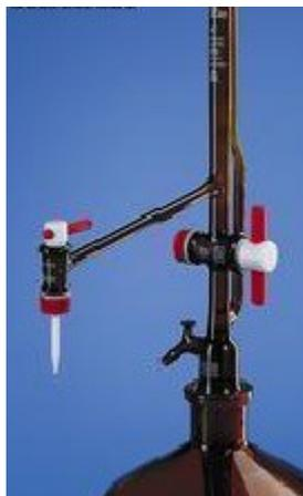
Caratteristiche principali: Con rubinetto di ritorno in bottiglia e rubinetto a squadra. In vetro borosilicato perfettamente incolore e resistente ai reagenti aggressivi. In vetro giallo, graduazione bianca. DIN 12700. Cono NS 29/32. Accessori (forniti a parte): Bottiglie per burette (vedere sezione 01 Vetreria). Molle per coni (vedere sezione 04 Pinze/Morsetti/Bunsen). Monopalle in gomma (vedere sezione 12).
