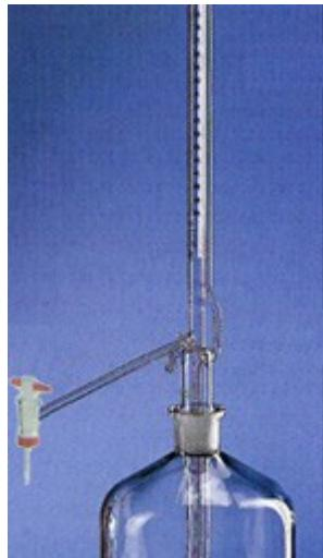
Caratteristiche principali: Graduata a caricamento ed azzeramento automatico. In vetro borosilicato perfettamente incolore e resistente ai reagenti aggressivi. Rubinetto di scarico laterale maschio PTFE. Cono 29/32. Accessori (forniti a parte): Bottiglie per burette (vedere sezione 01 Vetreria). Molle per coni (vedere sezione 04 Pinze/Morsetti/Bunsen). Monopalle in gomma (vedere sezione 12).
